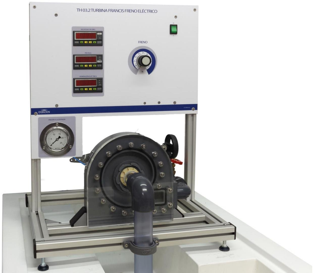
El equipo TH 03.2 simula una instalación a pequeña escala con una turbina de Francis o de reacción.
